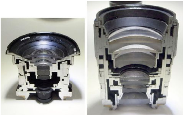
ラオア交換レンズのカットモデル。㊦15mmF4 ワイドマクロ。㊦105mmF2STF（後ろから4枚目がアポダイゼーションフィルター）
